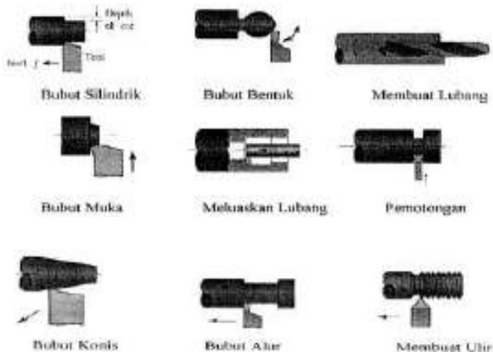
**Gambar 7.3** Proses Pada Mesin Bubut
