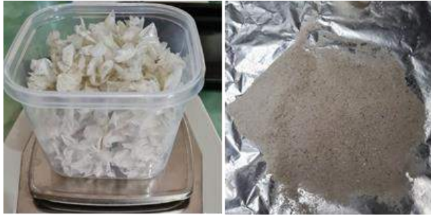
Gambar 17. Pengolahan sisik menjadi tepung sisik ikan
