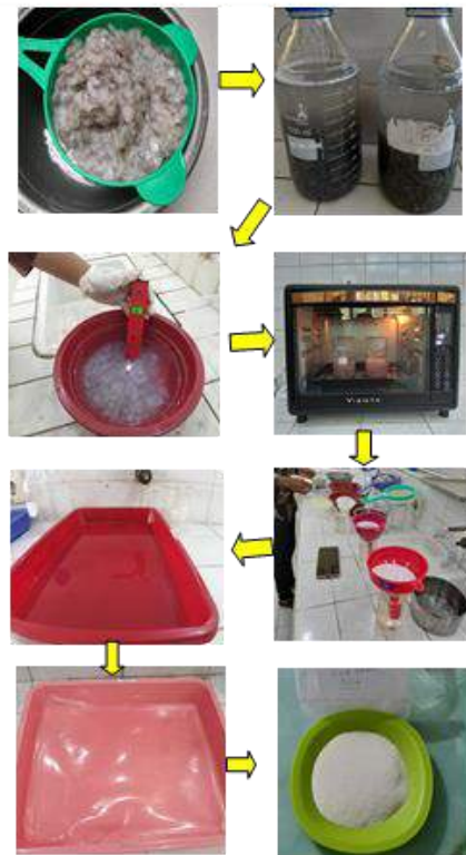
Gambar 16. Proses pembuatan tepung sisik ikan menjadi tepung gelatin
