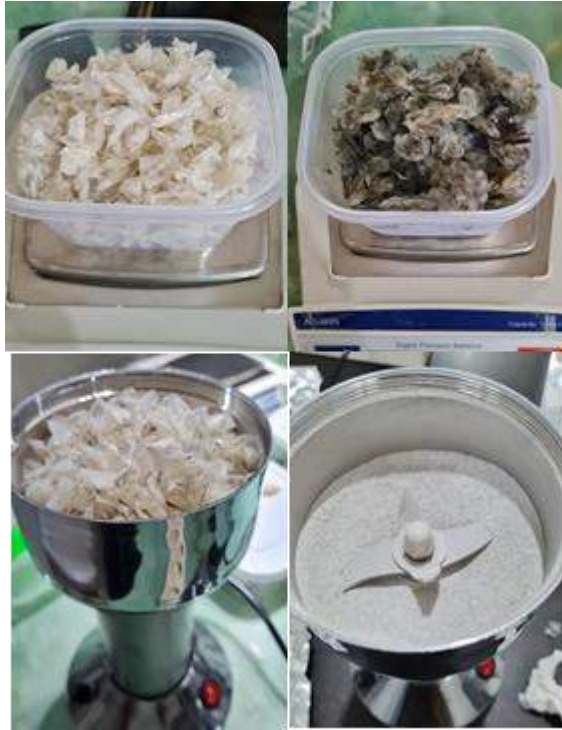
Gambar 14. Proses penepungan sisik ikan
