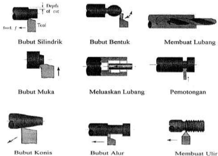
Gambar 7.3 Proses Pada Mesin Bubut
