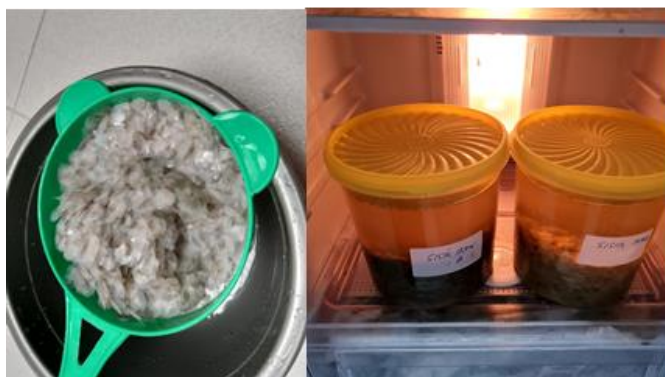
Gambar 7 Menunjukkan sisik ikan yang direndam selama 24 jam dalam larutan garam dalam lemari es. Hal ini dilakukan dengan tujuan untuk menghilangkan senyawa yang tidak bermanfaat yang terkandung dalam sisik ikan.
