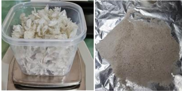
Gambar 17. Pengolahan sisik menjadi tepung sisik ikan
